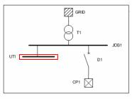
GRD (电源) T1(变压器) JDB1(供电主母线) D1 (断路器) CP1(负载) UT1(供电母线)
