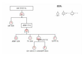
图 2 可靠性计算模型(关键供电母线的"故障逻辑树状图")
