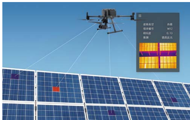
图2 无人机对光伏电池板中的巡检
