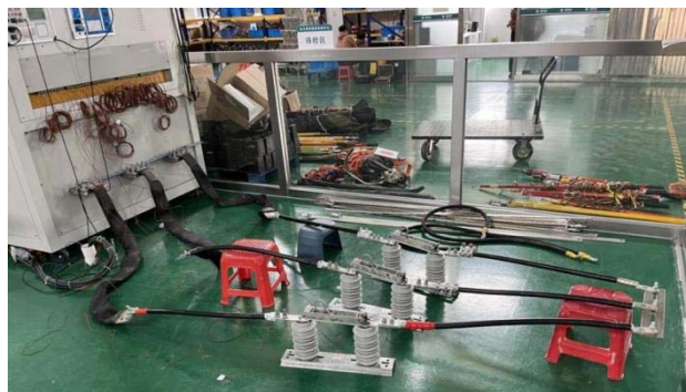
图2 温升试验现场接线
