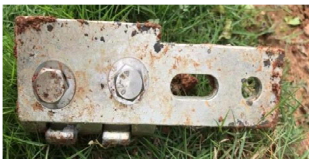
图1 铝合金线夹模拟盐雾试验结果
