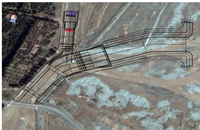
图3 原址修建,改变泄洪闸角度
