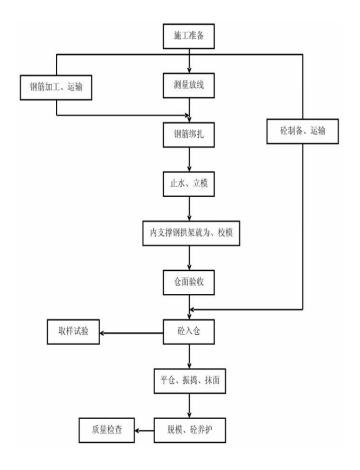
图一 引水渠道混凝土衬砌施工基本流程
