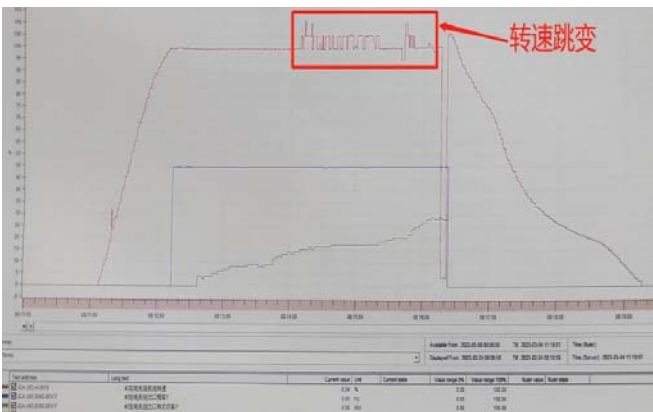
图2 #3机组开机并网后有功率、转速及频率变化曲线
