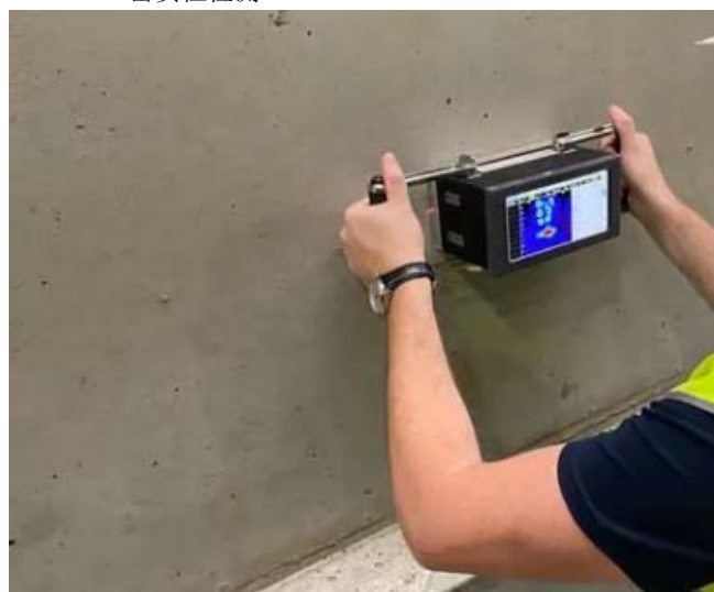
图1 水利工程混凝土超声波检测
